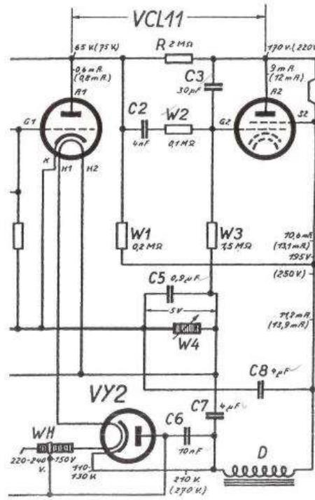
Abb. 5 Schaltung des DKE-Allstrom
